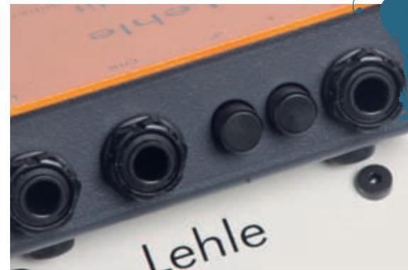
zwei Amp-Eingänge ohne Störgeräusche mit einem Instrument verbinden. Dank des dazugehörigen Phasenumkehrschalters kann man dabei auch etwaige Phasenprobleme zwischen den beiden Verstärkern ausmerzen.
